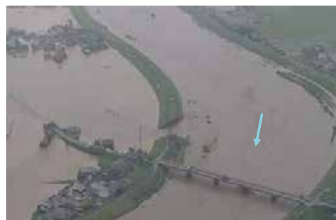
④浸透破壊による堤防の決壊
